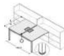
Bench per comby piano con top access, gambe a ponte "Q" prof.165,2
