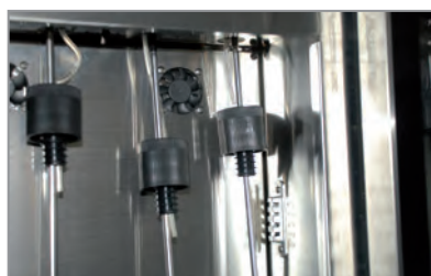
Sistema di immissione azoto e aspirazione del vino Nitrogen input system and wine aspiration
